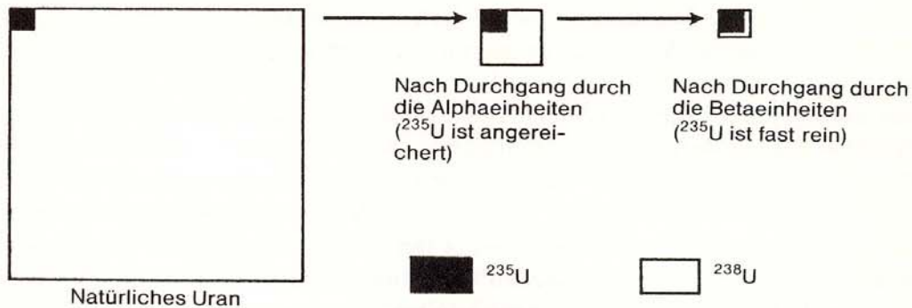
Abb. 11. Massenverhältnisse der Uranisotope bei den elektromagnetischen Trennanlagen
