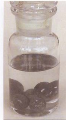
Kalium wird in einer mit Petroleum gefüllten Flasche aufbewahrt
