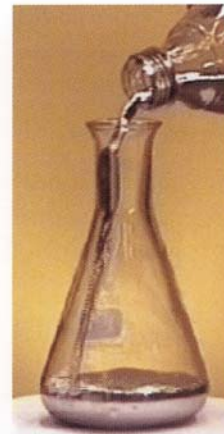
Quecksilber ist bei Raumtemperatur flüssig
