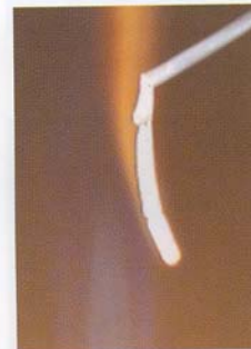
Ein zum Schmelzen erhitzter Aluminiumdraht knickt ohne dass das Metall abläuft
