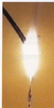
Magnesium brennt nach dem Entzünden an der Luft mit blendend weisser Flamme
