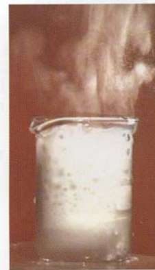
Calcium reagiert heftig mit Wasser unter Bildung von Wasserstoff und Löschkalk
