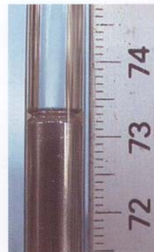
Das Quecksilberbarometer dient zur präzisen Messung des Luftdrucks
